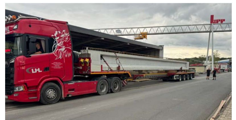
Insgesamt zwölf Spannbetonbinder mit jeweils 56 Spannstahlilitzen, 23 Meter Länge und 38 Tonnen Gewicht wurden auf Grundlage eines ausgeklügelten Logistikkonzeptes auf die Reise nach Erkrath geschickt. Zusammen mit den ebenfalls vom OSW gefertigten 68 TT-Platten dienen die Binder als tragende Elemente der neuen Turnhalle auf dem Schulcampus Sandheide.
